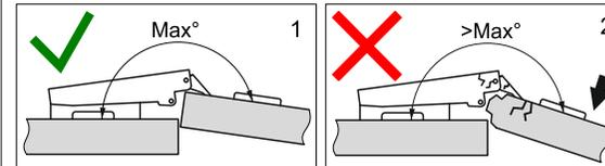
Петли фасада открываются на фиксированный угол (см. схему 1). Открывание фасада на больший угол (см. схему 2) может привести к повреждению деталей и поломке петель.
