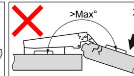
Петли фасада открываются на фиксированный угол (см. схему 1). Открывание фасада на больший угол (см. схему 2) может привести к повреждению деталей и поломке петель.
